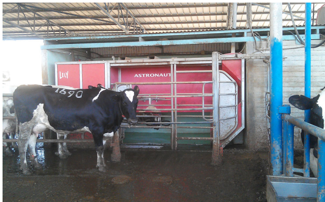
Hvis besøgsfrekvensen i malkerobotten skal være høj, kræver robotens placering at der tages hensyn til, at køerne helst vil opholde sig velventilerede steder i stalden.
